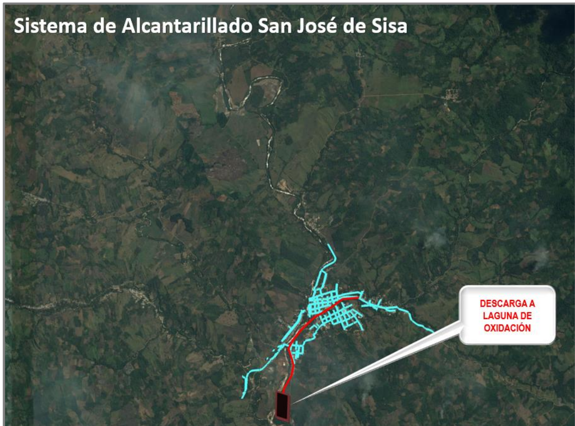
Imagen N° 31: Esquema del sistema del sistema de alcantarillado – San José de Sisa
