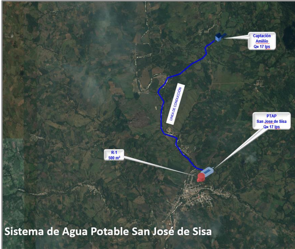
Imagen N° 30: Esquema del sistema del sistema de agua potable – San José de Sisa
